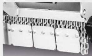
**Láminas con cadenas de protección atornilladas**
