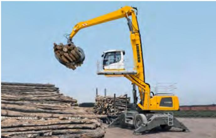
LH 50 M Industry Litronic en modo remolque manipulando maderas redondas
