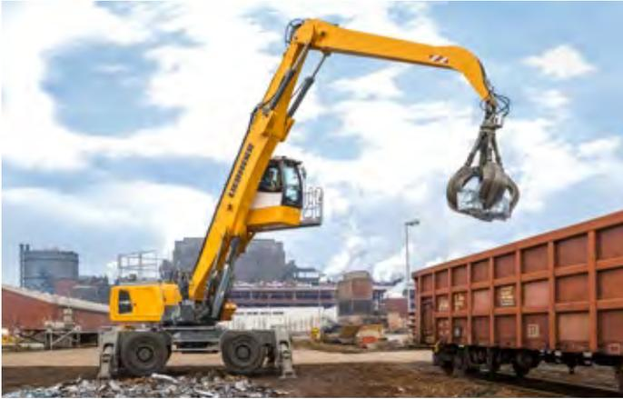
Carga en vagones de paquetes de aluminio prensados con la LH 50 M Industry Litronic
