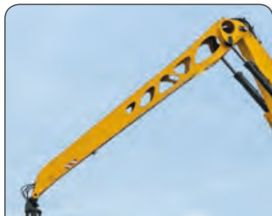
Lanzamiento del balancín de construcción ligera
